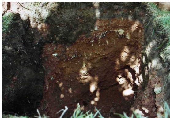
Abb. 27: Übergang von Auflageschicht zum Haldenmaterial
